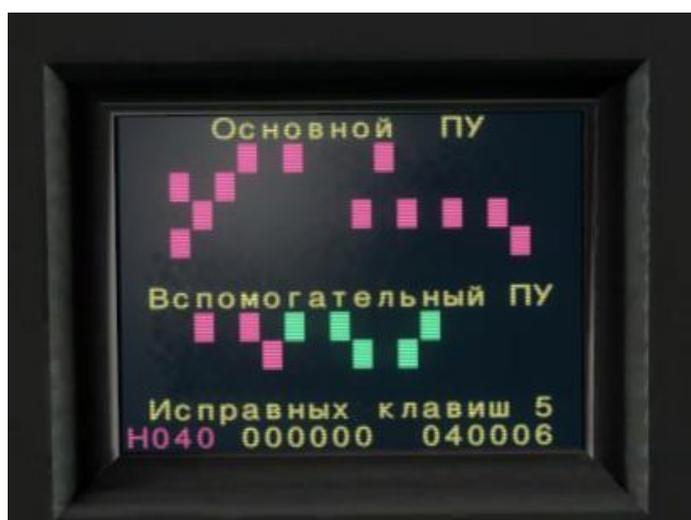
После проверки кнопок нажать кнопку «ВВ» для перехода на главный экран.
