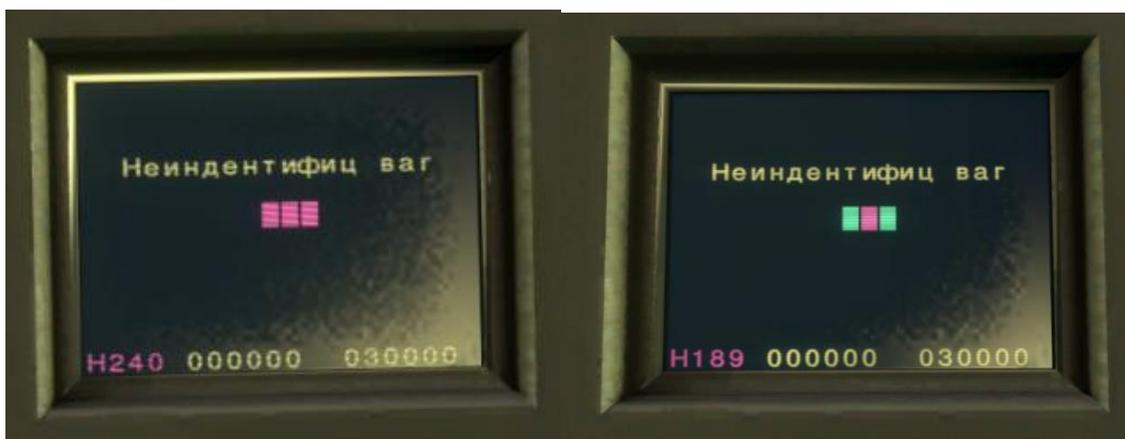
Дальше машинист должен проверить кнопки на ОПУ «Передача управления», «Закрытие дверей», «Восприятие сообщения», «Восприятие торможения», «Бдительность», проверить на ВПУ «ББЭ», «Компрессор» и «Освещение салона». Количество исправных кнопок будет указано снизу, а исправные кнопки подсвечиваются зелёным цветом.
