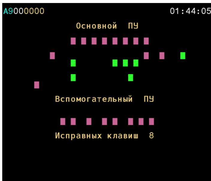
После проверки кнопок нажать кнопку «Ввод» для перехода на главный экран.
