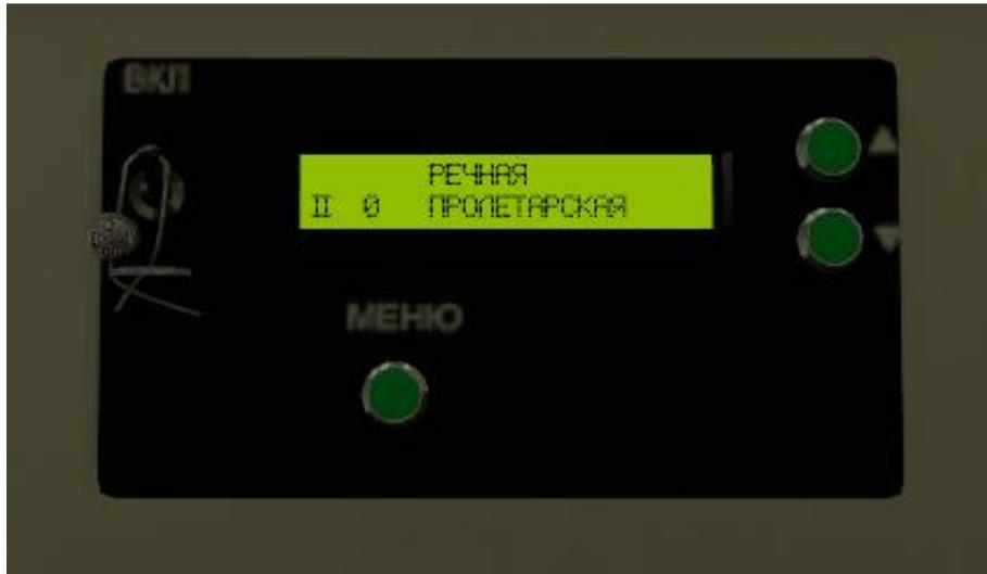
Устройства автоматического считывания номера маршрута поезда (**АСНП**) предназначены для передачи с каждой станции на центральный пункт к устройствам диспетчерской централизации (**ДЦХ**) следующей информации:
