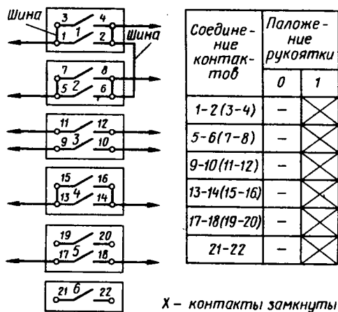
Рис. 3.57. Электрическая схема выключателя ВВ-13В
