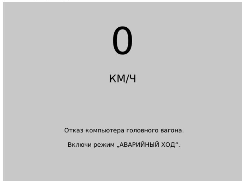
Активация режима АВАРИЙНЫЙ ХОД проводится машинистом переключением выключателя «ВРУ» на пульте машиниста вспомогательном ПМВ в положение „АХ“. Тяговые приводы отдельных вагонов в данном режиме управляются напрямую с помощью проводов. В режиме АВАРИЙНЫЙ ХОД движение поезда возможно только вперед.
