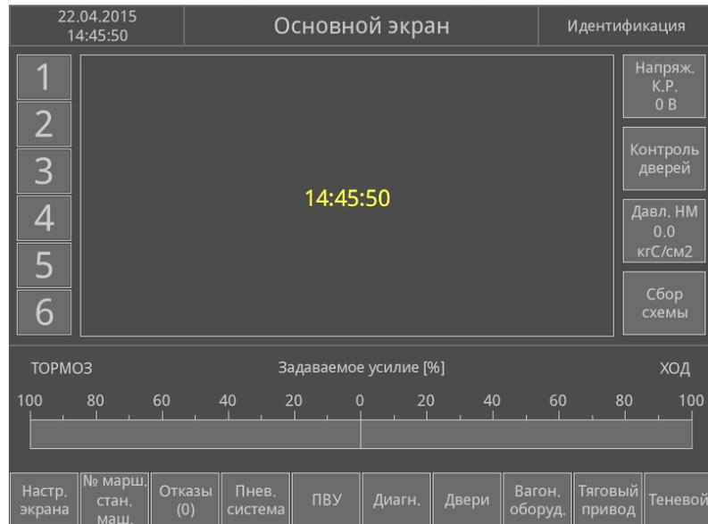
После включения бортовой сети на экране блока монитора БМЦИК-01 цифрового информационного комплекса в обеих кабинах машиниста включится подсветка и появится надпись «Блок неактивен»:
